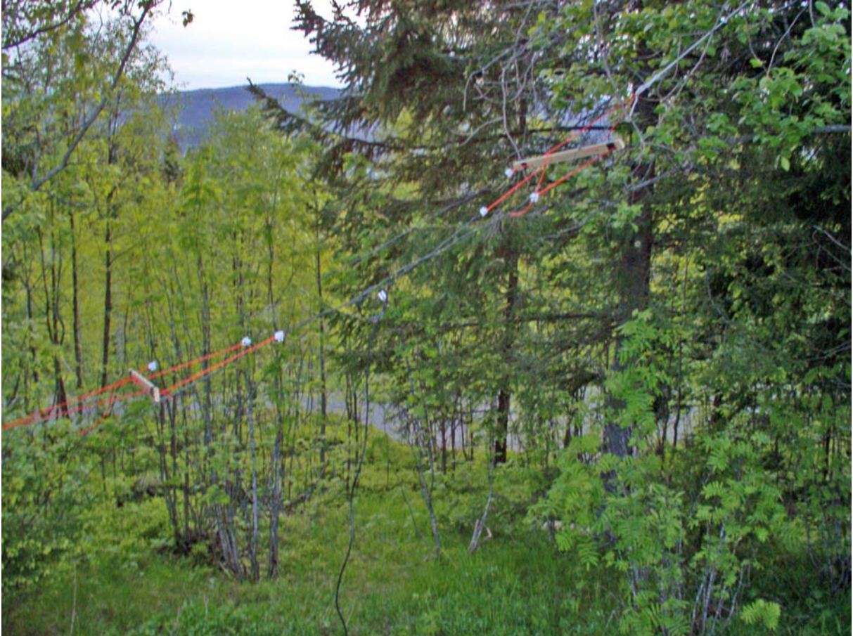
Figur 8: Første felttest med trådyagien hengt opp mellom 2 tre.
