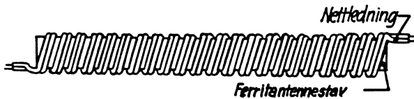
Fig. 6. Kjernelengde 240 mm. Kjernediameter 10 mm. Nettledningen vikles opp hele lengden av ferritt-antennestaven. Filteret plasseres så nær mottakeren som mulig.
